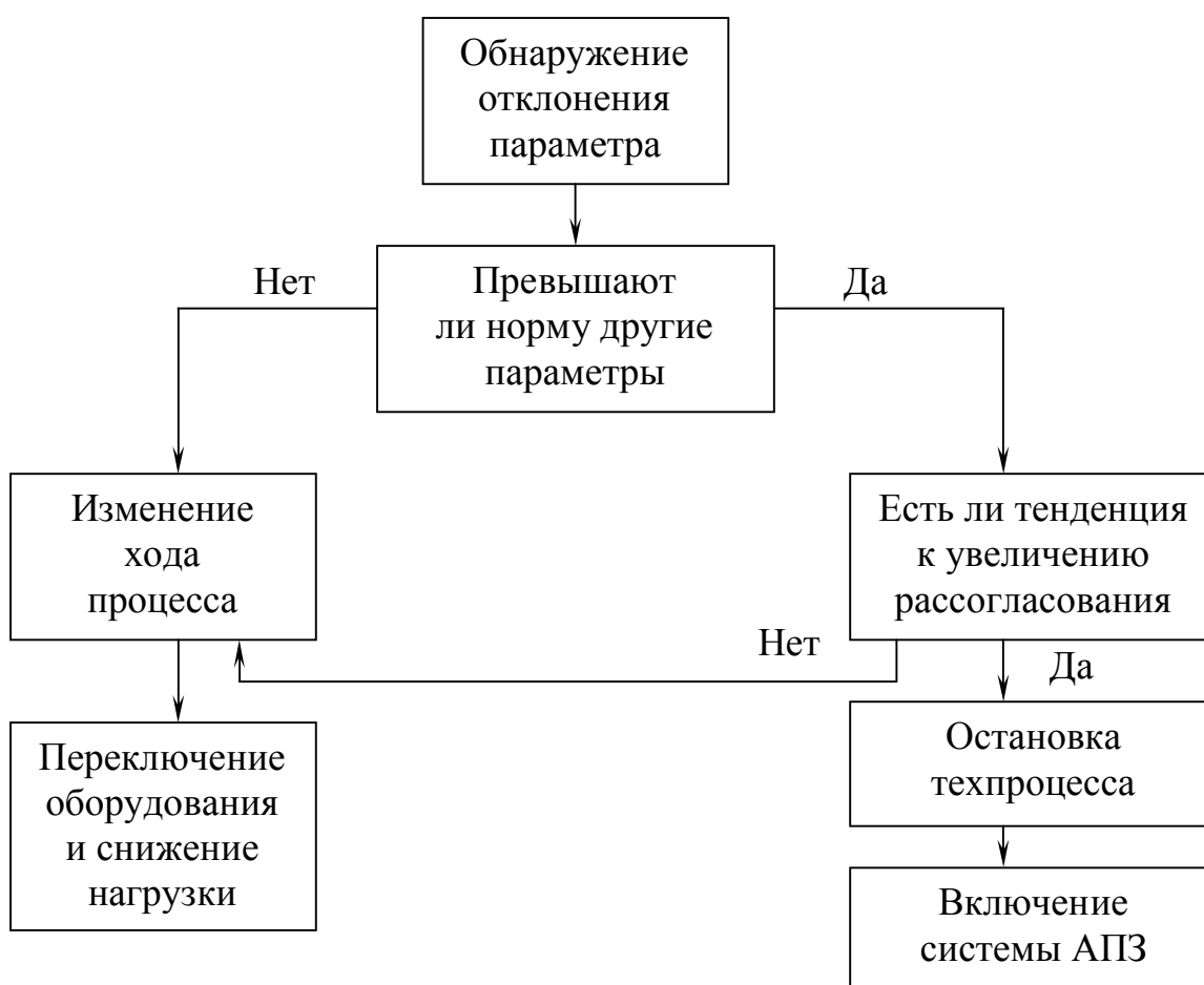
Рис. 9.8. Блок-схема программы анализа аварийного сигнала
